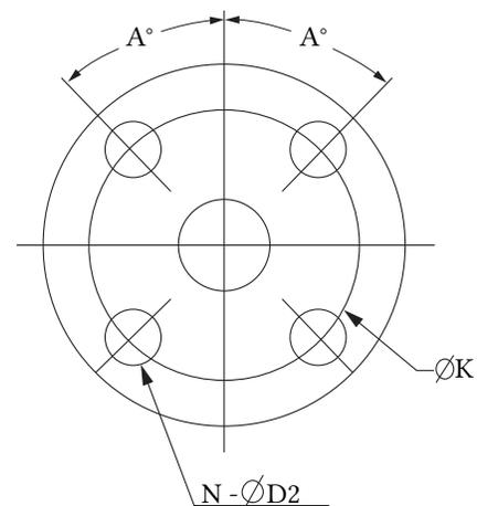
Trous de boulons appliqués uniformément, symétriquement à l'axe.
