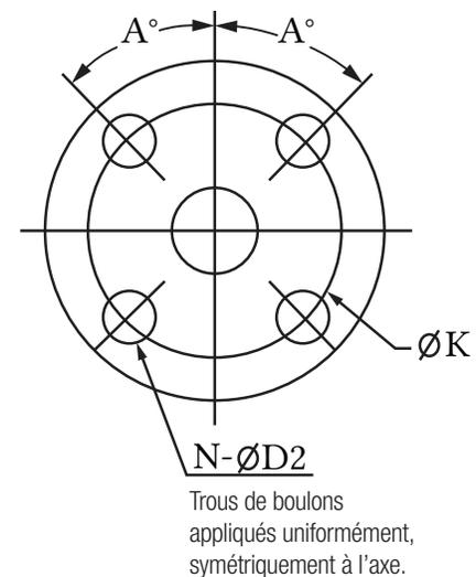
\*Assemblages à brides : la capacité de pression de l'ensemble vanne et bride est limitée à la bride et non à la vanne.
